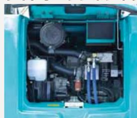
低い位置で大きく開くボンネット構造を採用。エアクリーナ、エンジンオイルフィルタ、ラジエータリザーバタンクなどを見やすく触りやすい位置にレイアウトし、地上からすばやく点検・整備が行えるよう配慮しています。
