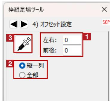
① 配置した枠組足場を選択し、[左右][前後]の移動量（マイナス可）を入力します
