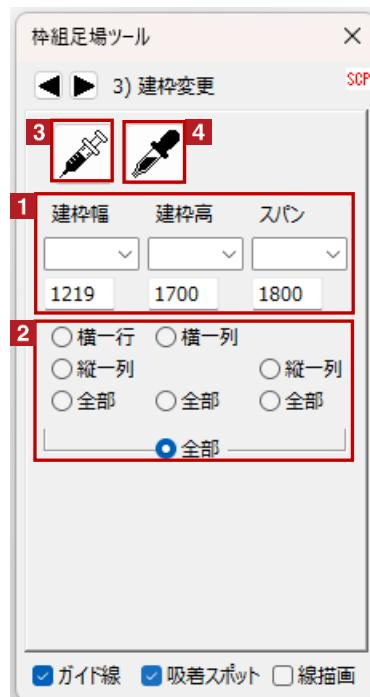
① 配置した枠組足場を選択し、[建枠幅][建枠高][スパン]を変更します
