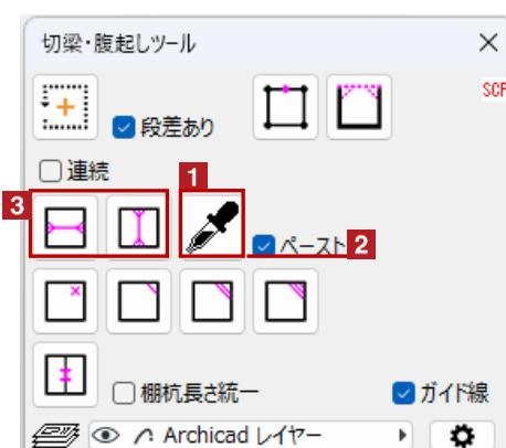
① 配置した切梁・腹起しを選択し、[ペースト] をクリック後、設定をコピーしたい切梁をクリックします
