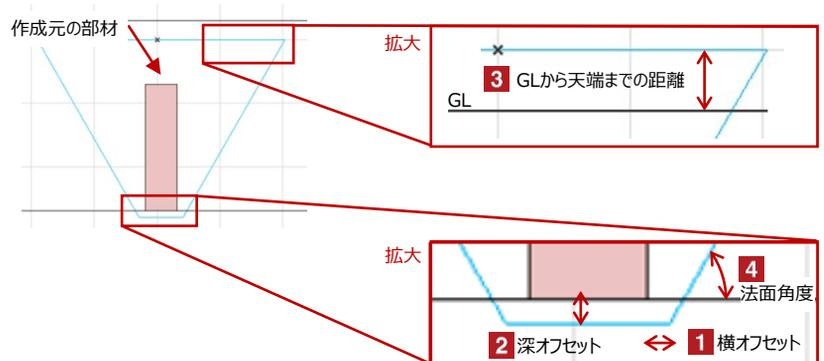
※深さ方向へのオフセットは、部材の底面の法線方向への長さになるように作図されます
