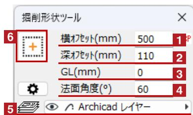
1 横オフセット（軸体側面から法尻までの距離）を設定します
