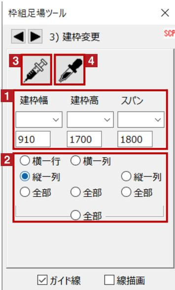
1 配置した枠組足場を選択し、[建枠幅][建枠高][スパン]を変更します
