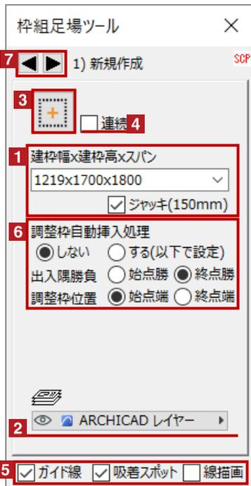
**1** 建枠幅 x 建枠高さ x スパン長さで形式を選択します
